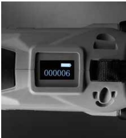
L'affichage indique l'état de charge de la batterie, les informations de service et le nombre de sertissages.
